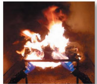
Una vez eliminada la fuente de llama se mide la longitud de la cinta que no se ha dañado, bien midiéndolo físicamente ó por medios matemáticos. Las instalaciones de pruebas internas de Fenner Dunlop están diseñadas y fabricadas de acuerdo con la norma EN 1288-1 (sección 6) Ensayo de Propagación de Fuego de Media Escala y son las únicas instalaciones de este tipo en funcionamiento en el Reino Unido.
